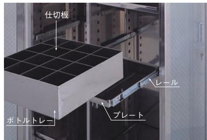
■プレートにレールを取付け、レール受けに挿入します。プレートの上にボトルトレイを置けば設置完了です。簡単な組立て操作で安全にボトル管理ができます。
