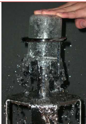
■ビーカー(200ml)の洗浄 少し倒して角度を変えて洗浄すると底まで洗えます。 ※口径が広いものは水が跳ねかえるため、深い水槽が囲いを御用意下さい。
