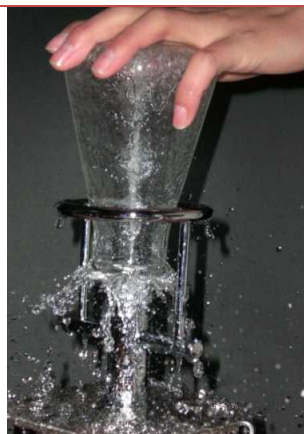
■三角フラスコ(300ml)の洗浄 容器の角度を変えながら洗浄すると、容器の底のR部分まで洗うことができます。 ※水の跳ね返りが多くなるため深い水槽が囲いをご用意下さい。
