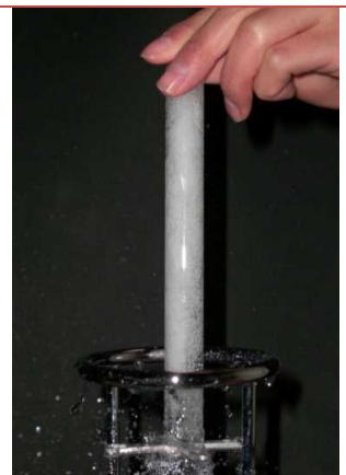
■丸底容器の洗浄 口内径20mm以上の丸底容器や円沈管などの洗浄も可能。 ※細口容器は水の吐出と排出の流れが悪くなり、洗浄効果がでないことがあります。
