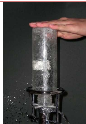
■ペットボトルの洗浄 胴径60mm・全高184mm 口内径30mm 容器を少し斜めに倒しながら洗浄すると容器の底が綺麗に洗えます。
